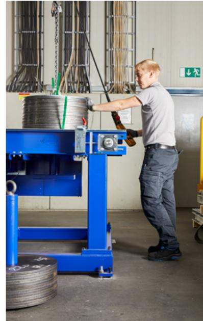
Einfaches Aufsetzen der Rondenstapel
