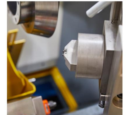
An einer HABS werden die Ronden im zweiten Schritt beschnitten und entgratet.
