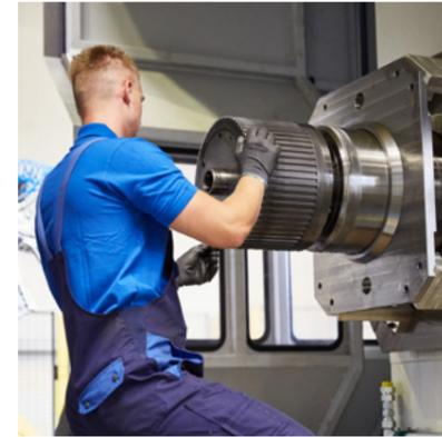
Rundlaufprüfung an einer HSTR-Hauptspindel
