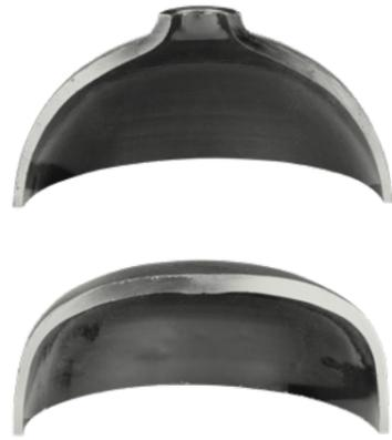
Unsere SFM-Baureihe wurde speziell für das Anformen von Böden und Flaschenhälsen an Rohren bzw. zylindrischen Vorformen konzipiert. Der Durchmesser eines Rohres wird dabei reduziert, das Rohrende vollständig gasdicht verschlossen. Mit einer SFM-Maschine können durch den einzigartigen WF-Schwenkform-Support beinahe beliebige Konturen im Schulter-/Halsbereich einer Gasflasche hergestellt werden.
